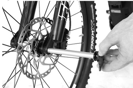
Abra el cierre rápido en el eje de tornillo e introduzca el eje ligeramente lubricado por el buje hasta la rosca de la puntera. Gire el eje para apretar y genere el pretensado moviendo la palanca 90° hacia arriba.
