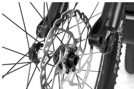
En las ruedas delanteras de la ROTWILD e-MTB se utilizan ejes de tornillo. Al colocar el buje de la rueda delantera, preste atención a que el buje esté firmemente asentado en las punteras y que el disco de freno esté centrado correctamente en la pinza de freno.
