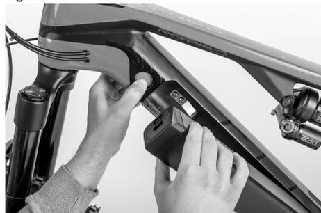
Vuelva a accionar el mecanismo de extracción para extraer la batería de propulsión del tubo inferior por el lateral.
