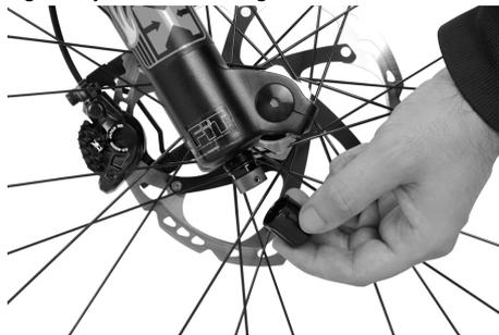
Una amortiguación demasiado escasa provoca una expansión muy rápida de la horquilla. Una amortiguación demasiado rígida provoca que la horquilla de la suspensión se hunda en caso de muchos baches seguidos, ya que no puede expandirse suficientemente rápido.
