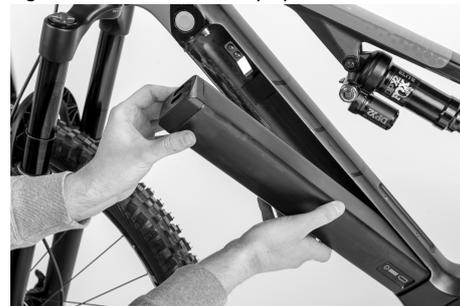
Una vez que la batería de propulsión se haya insertado en el soporte inferior del tubo inferior, se puede girar para introducirla lateralmente en el tubo inferior. La batería de propulsión debe encajar de forma audible en el cierre, en la zona superior del tubo inferior, para que asiente con seguridad en el tubo inferior y no se caiga.
