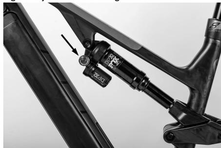
Para un ajuste correcto, el primer paso es girar la rueda de ajuste en el sentido contrario a las agujas del reloj hasta el tope. A continuación, el tornillo de ajuste se gira en pequeños pasos / clics en el sentido de las agujas del reloj hasta que se consiga el ajuste correcto de amortiguación.
