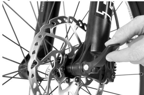
Fig 50: Montar la unión roscada del eje / rueda delantera
