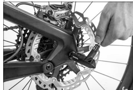
Fig. 57: Montaggio del sistema dell'asse della ruota posteriore
