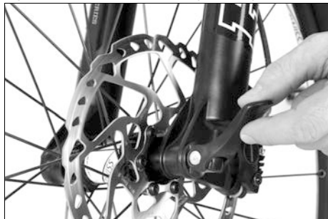
Fig. 56: Chiusura della leva di sgancio rapido
