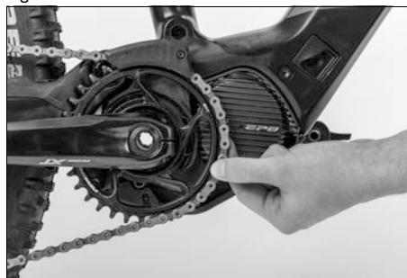
Fig. 23: Controllo dello stato della catena
