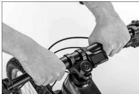
Fig. 38: Controllo dell'attacco manubrio
