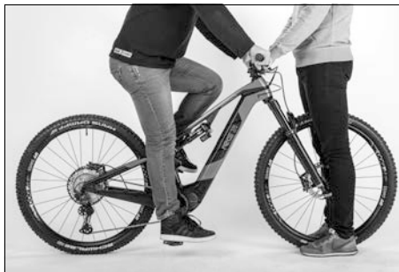
Fig. 39: Determinazione dell'altezza corretta della sella
