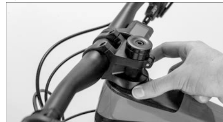
Fig. 37: Gioco della serie sterzo
