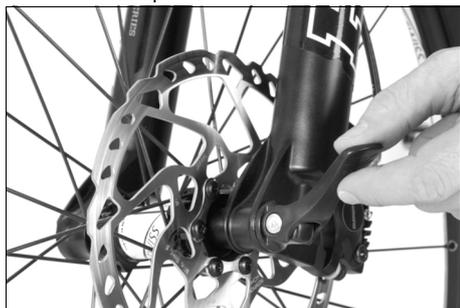
Abb. 50: Montage der Achsverschraubung / Vorderrad
