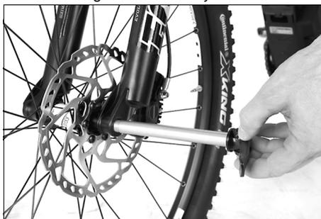
Klappen Sie den Schnellspanner an der Schraubachse auf und schieben Sie die leicht gefettete Achse durch die Nabe bis das Gewinde im Ausfallende gegenüber greift. Drehen Sie die Achse fest und bringen Sie die Vorspannung auf, indem Sie den Spannhebel um 90° nach oben umlegen.
