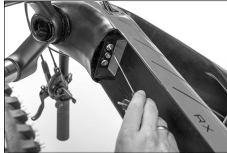
Nachdem Sie die Vorspannung der Antriebsbatterie angepasst haben, montieren Sie wieder die beiden äußeren Senkkopfschrauben sowie die zentrale Zylinderkopfschraube mit den vorschriebenen Drehmomenten (siehe "Empfohlene Anzugsdrehmomente" auf Seite 77).
