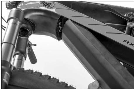
Sichern Sie abschließend die Antriebsbatterie mit dem Sicherungsstift im Unterrohr. Drücken Sie hierzu den Antriebsbatterieverschluss etwas nach oben und stecken Sie den Sicherungsstift in die hierfür vorgesehene Öffnung.
