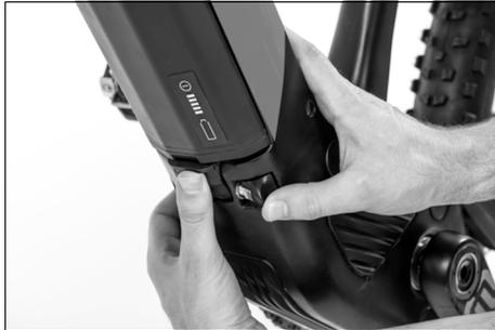
Nehmen Sie den Sicherungsstift heraus. Entlasten und sichern Sie die Antriebsbatterie mit einer Hand gegen Herausfallen. Drücken Sie mit der anderen Hand den Antriebsbatterieverschluss nach unten und senken Sie die Antriebsbatterie.
