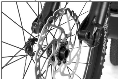
Bei den Vorderrädern der ROTWILD e-MTB kommen Schraubachsen zum Einsatz. Achten Sie beim Einsetzen der Vorderradnabe darauf, dass die Nabe fest in den Ausfallenden sitzt und die Bremsscheibe korrekt im Bremssattel zentriert ist.
