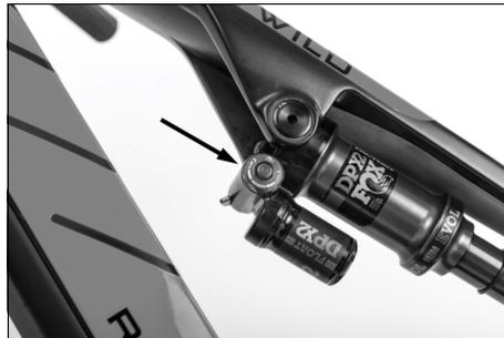
Zur richtigen Einstellung wird das rote Einstellrad im ersten Schritt bis zum Anschlag gegen den Uhrzeigersinn gedreht. Anschließend wird in kleinen Schritten / Klicks im Uhrzeigersinn die Einstellschraube gedreht bis die richtige Stoßdämpfereinstellung eingestellt ist.
