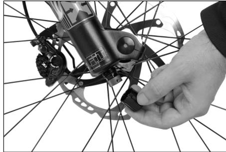
Zu geringe Dämpfung führt zu einem sehr schnellen Ausfedervorgang der Gabel. Zu straffe Dämpfung bewirkt, dass die Federgabel bei schnell aufeinanderfolgenden Stößen zusammensinkt, da sie nicht mehr schnell genug ausfedern kann.
