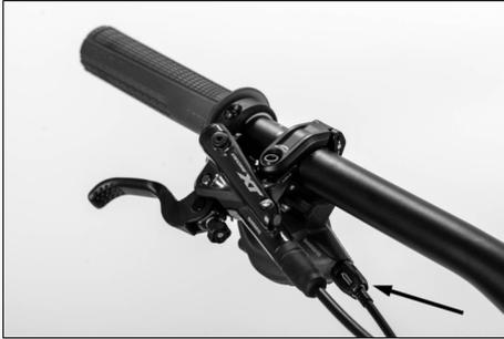
Abb. 22: Endanschlagschrauben
