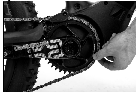
Fig. 19: Contrôler l'état de la chaîne
