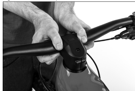
Fig. 34: Contrôler la potence
