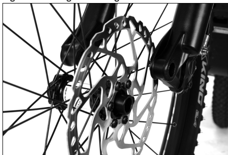
Fig. 48: Montage du vissage d'essieu / roue avant
