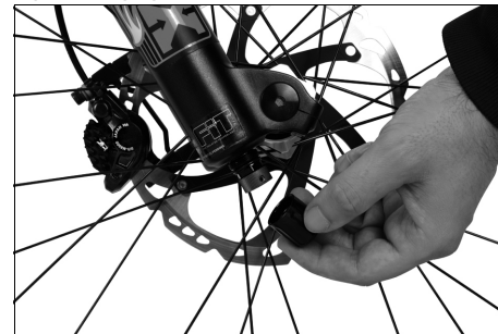
Fig. 43: Réglage de l'amortisseur
