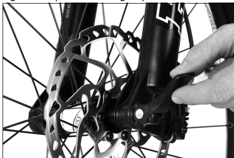
Fig. 48: Montage du vissage d'essieu / roue avant
