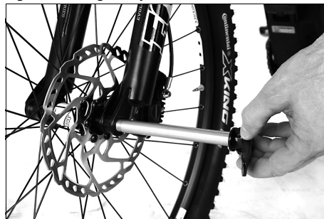
Fig. 49: Montage du système d'essieu de roue avant
