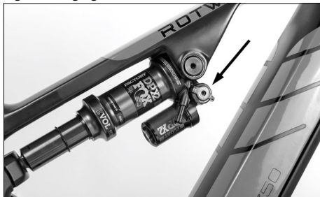
Fig. 45: Réglages de l'amortisseur
