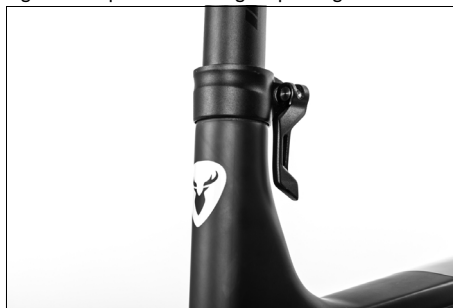
Fig. 38: Dispositif de serrage rapide/tige de selle
