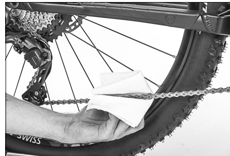
Fig. 18: Graisser la chaîne
