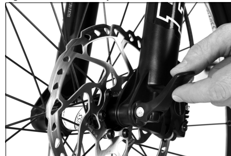
Fig. 50: Fermeture du système d'essieu de roue avant
