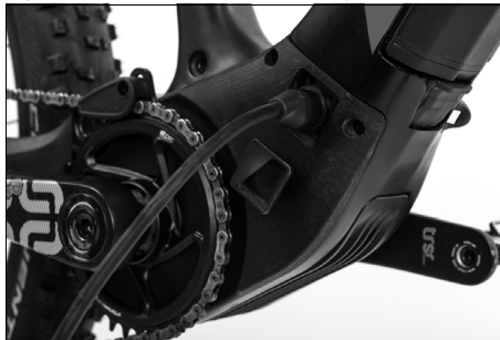
Fig. 24: Fiche de connexion dans la position correcte
