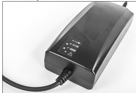
Fig. 23: Aperçu des voyants de contrôle
