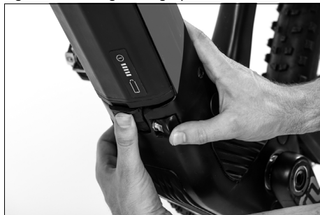
Fig. 26: Desserrage de la goupille de sécurité
