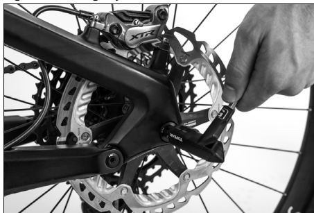
Fig. 51: Montage système d'essieu de roue arrière
