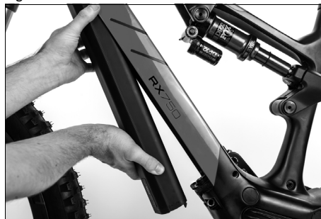
Fig. 27: Retrait de la batterie de transmission
