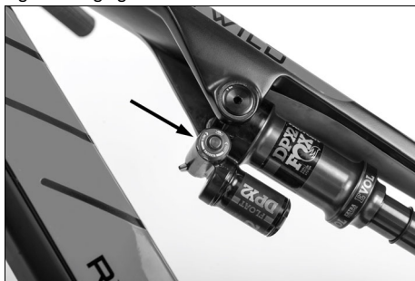
Fig. 46: Réglage de l'amortissement
