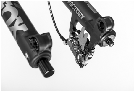
Fig. 52: Cale de transport du frein à disques
