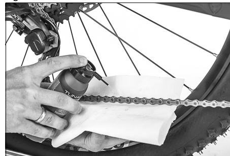
Fig. 18: Graisser la chaîne
