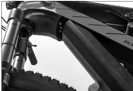
Fig. 28: Montage de la batterie de transmission
