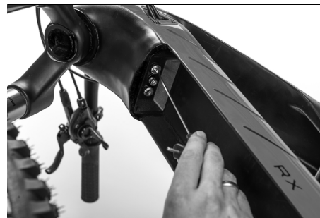
Fig. 30: Réglage de la précontrainte de la batterie de transmission
