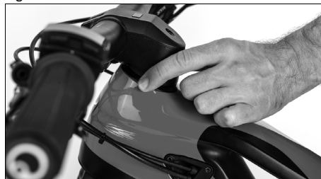
Fig. 33: Jeu de l'ensemble de direction
