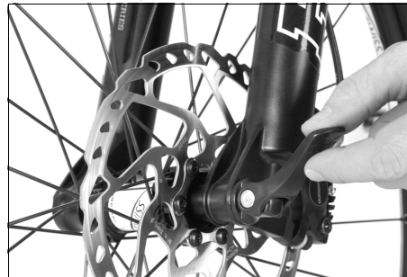
Abb. 48: Montage der Achsverschraubung / Vorderrad
