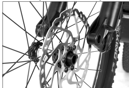
Abb. 48: Montage der Achsverschraubung / Vorderrad
