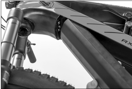
Abb. 27: Einbau der Antriebsbatterie
