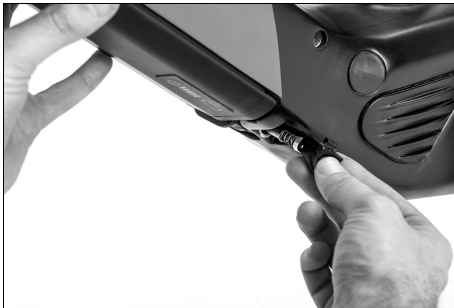
Abb. 28: Sichern der Antriebsbatterie
