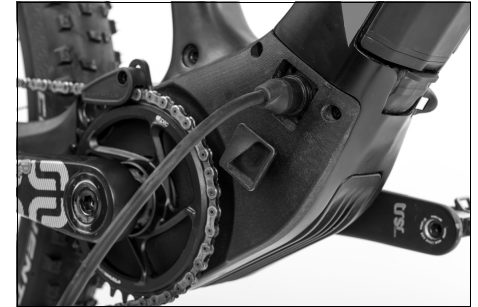
Abb. 6: Ladekabel Stecker / Antriebsbatterie
