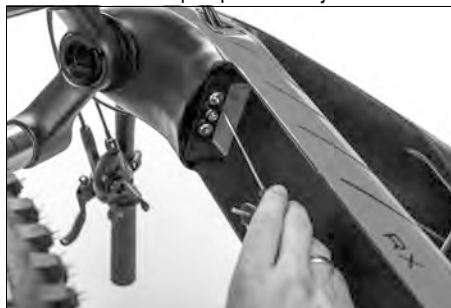
Obr. 34: Nastavenie predpätia hnacej batérie
