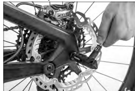
Obr. 57:Montáž systému osi zadného kola
