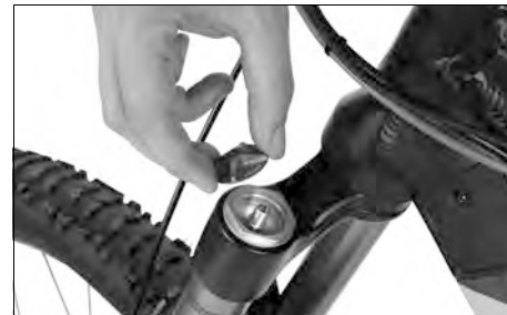
Obr. 45: Ventil na nastavenie tlaku vzduchu vo vidlici
