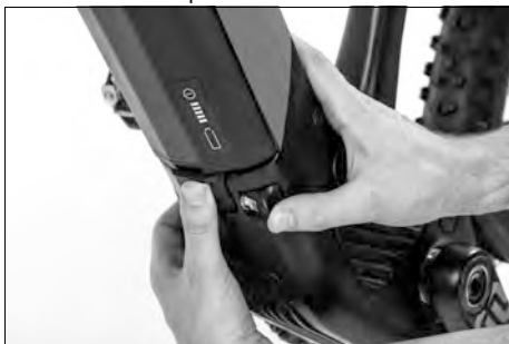
Obr. 31:Uvoľnenie poistného kolíka
