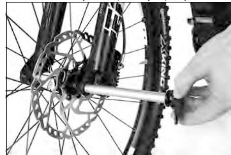
Obr. 55: Montáž systému prednej nápravy
