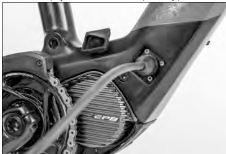
Obr. 23: Pripojovací konektor v správnej polohe
