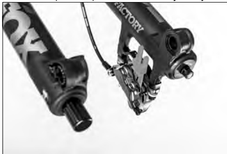
Obr. 58:Prepravná poistka kotúčovej brzdy
