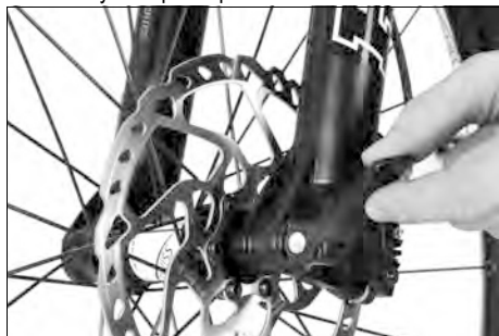
Obr. 54: Montáž skrutkového spoja osky/predné
