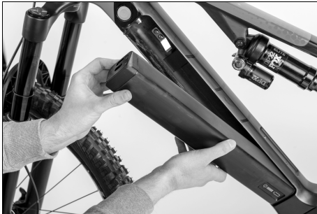
Abb. 20: Einbau der Antriebsbatterie
