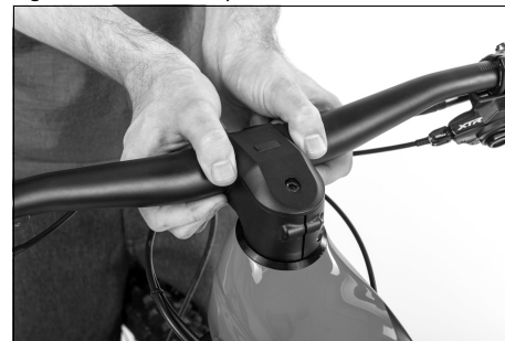
Figure 33: Contrôler la potence
