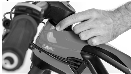
Figure 32: Jeu de l'ensemble de direction
