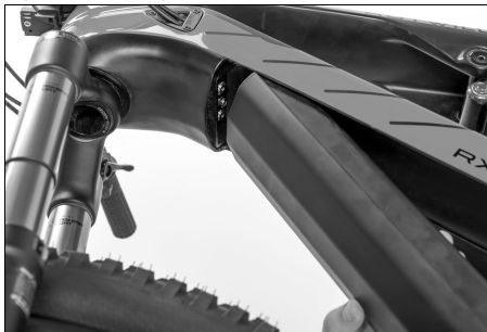
Figure 27: Montage de la batterie de transmission
