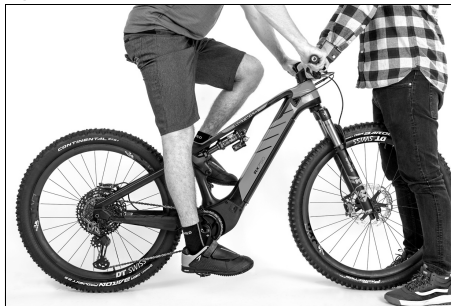
Figure 34: Calcul de la bonne hauteur de selle
