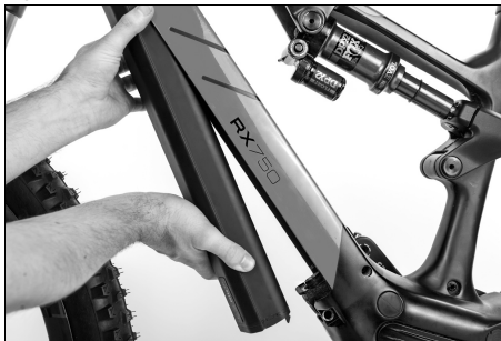
Figure 26: Retrait de la batterie de transmission
